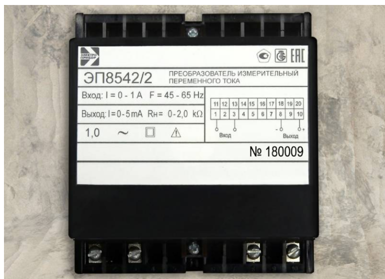
Рисунок 1 – Общий вид ИП в корпусе с габаритными размерами 110×120×70 мм (при креплении на винты) или 110×120×81 мм (при креплении на DIN – рейку)
