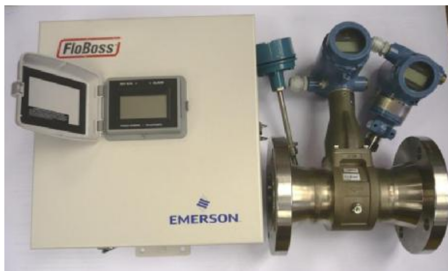
в) Комплекс Метран-490 с контроллером FloBoss 107
