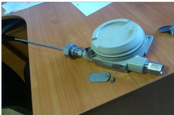
рис. 1 Вид преобразователей с ТС
