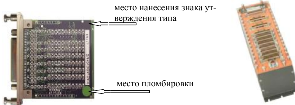
Рисунок 1 - Внешний вид модуля KAD/ADC/011 и модуля KAD/ADC/011 установленного в шасси KAM/CHS/13U
