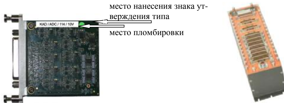
Рисунок 1 - Внешний вид модуля KAD/ADC/114/10V и модуля KAD/ADC/114/10V установленного в шасси КАМ/СНС/13U
