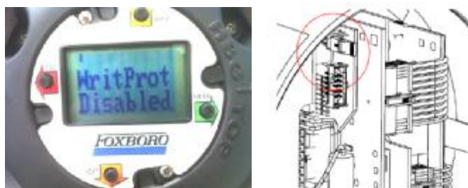
Рисунок 3 – Микропереключатели находятся в положении «WRITE PROTECT DISABLED», на экран выводится сообщение о том, что прибор в настоящий момент не защищен от внешнего вмешательства.
