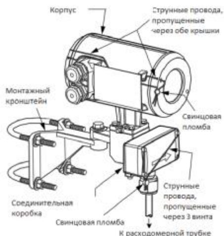
Рисунок 5 – Схема пломбировки измерительного преобразователя CFT50 от несанкционированного доступа.
