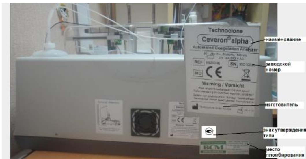
Рисунок 2 – Схема маркировки и пломбировки
