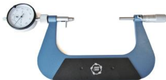
Рисунок 2 - Общий вид микрометра рычажного типа МРИ
