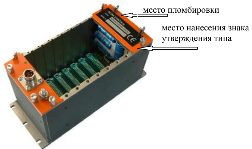
Рисунок 2 - Внешний вид блока КАМ/СНС/06U
