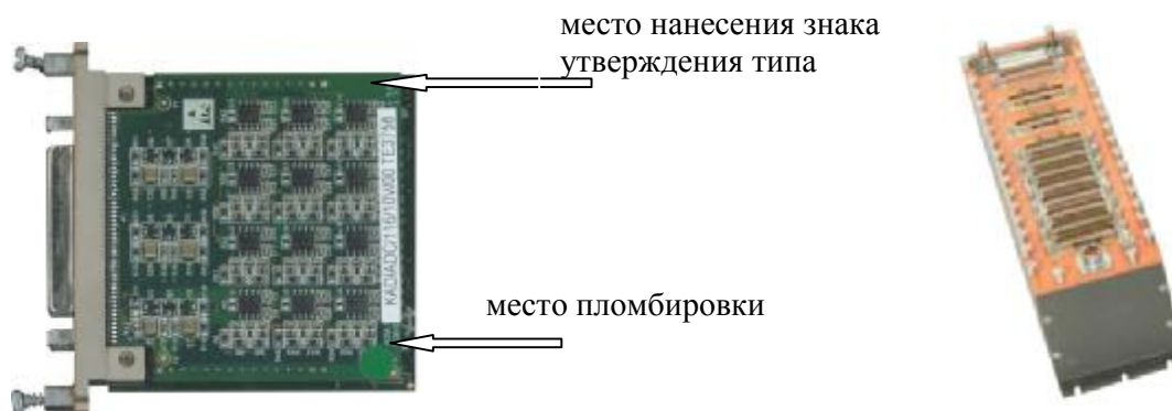
Рисунок 1 - Внешний вид модуля KAD/ADC/116 и модуля KAD/ADC/116 установленного в шасси KAM/CHS/13U
