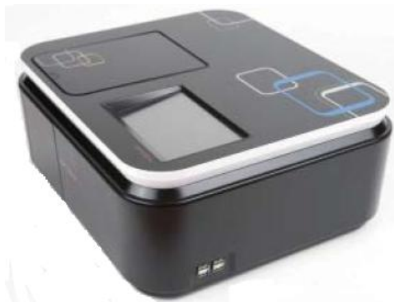
Рисунок 6 - Общий вид спектрофотометра OPTIZEN POP QX
