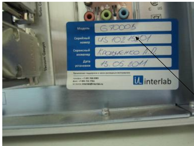
Рисунок 6. Место пломбирования для защиты от несанкционированного доступа
