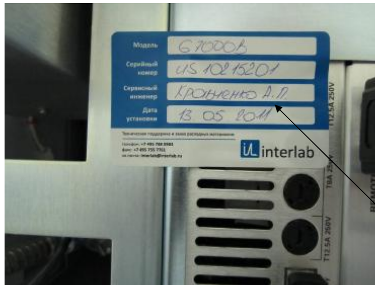
Рисунок 5. Место пломбирования для защиты от несанкционированного доступа
