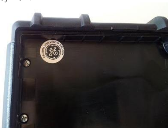
Рисунок 2 – Схема пломбировки электронного блока толщиномера от несанкционированного доступа
