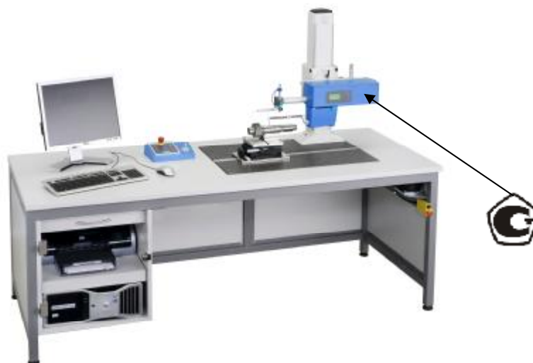
Рисунок 1 - Общий вид прибора для измерений параметров шероховатости, волнистости и профиля поверхности HOMMEL-ETAMIC T8000
