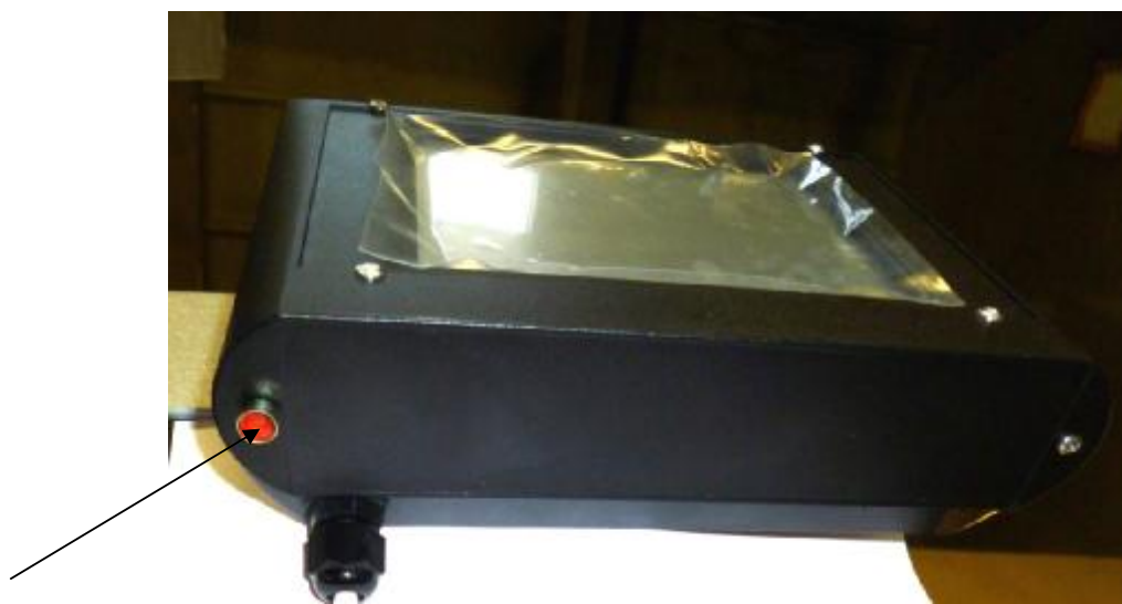
Рисунок 1. Схема пломбировки микропроцессорного блока управления от несанкционированного доступа.
