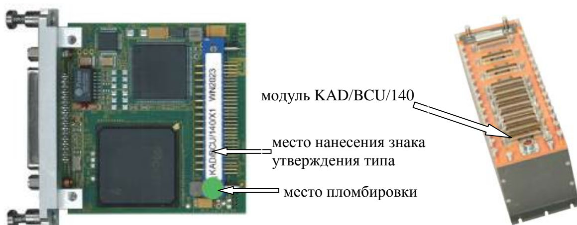
Рисунок 1 - Внешний вид модуля KAD/BCU/140 и модуля KAD/BCU/140 установленного в блоке базовом КАМ/СНС/13U
