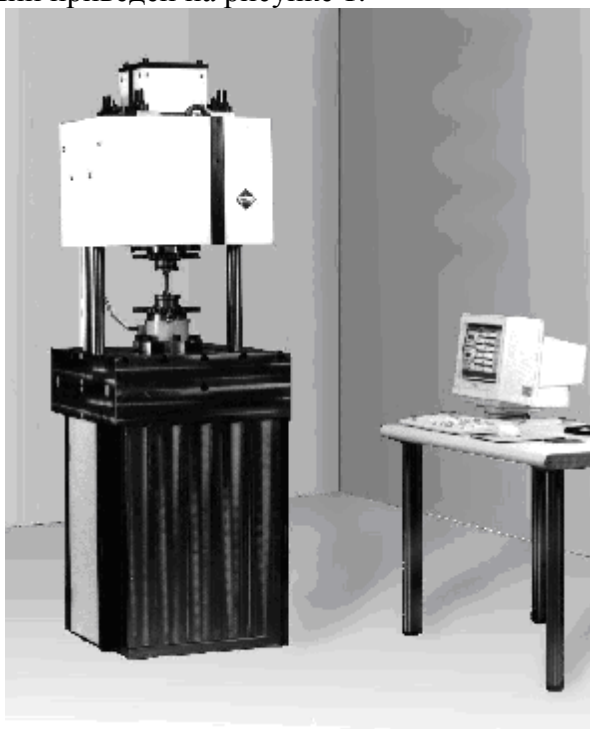
Рис. 1. Общий вид машин испытательных резонансных TESTRONIC
