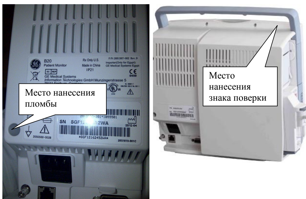
Рисунок 2 - Схема пломбировки от несанкционированного доступа, обозначение места нанесения знака проверки
