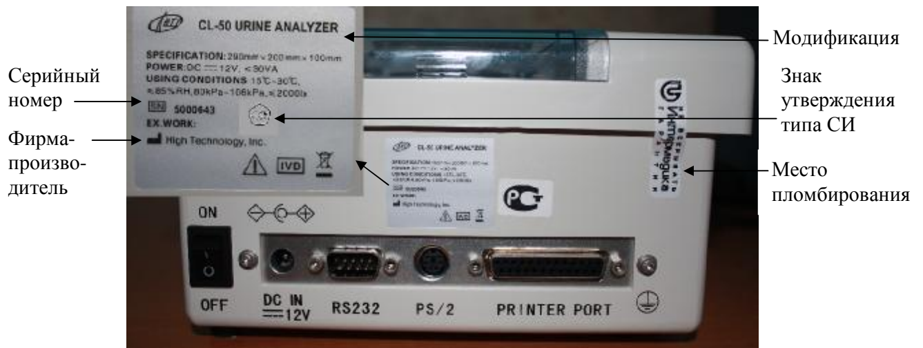
Рисунок 3 – Схема маркировки и пломбировки анализаторов CL-50
