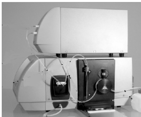
Рис.3 Внешний вид анализаторов Alcolyzer Beer ME, Alcolyzer Spirits ME и Alcolyzer Wine ME в комплекте с подключенным анализатором плотности жидкости серии DMA
