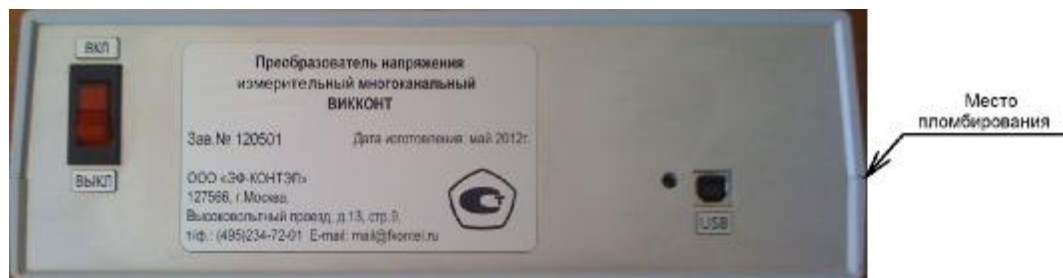
Общий вид передней панели преобразователей напряжения измерительных многоканальных «ВИККОНТ»
