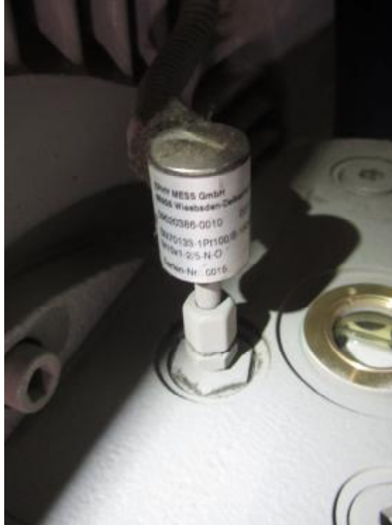
Рис. 1. Термопреобразователь сопротивления платиновый SN70133-1PT100/B-150x6S-M10x1-2/5-N-O.
