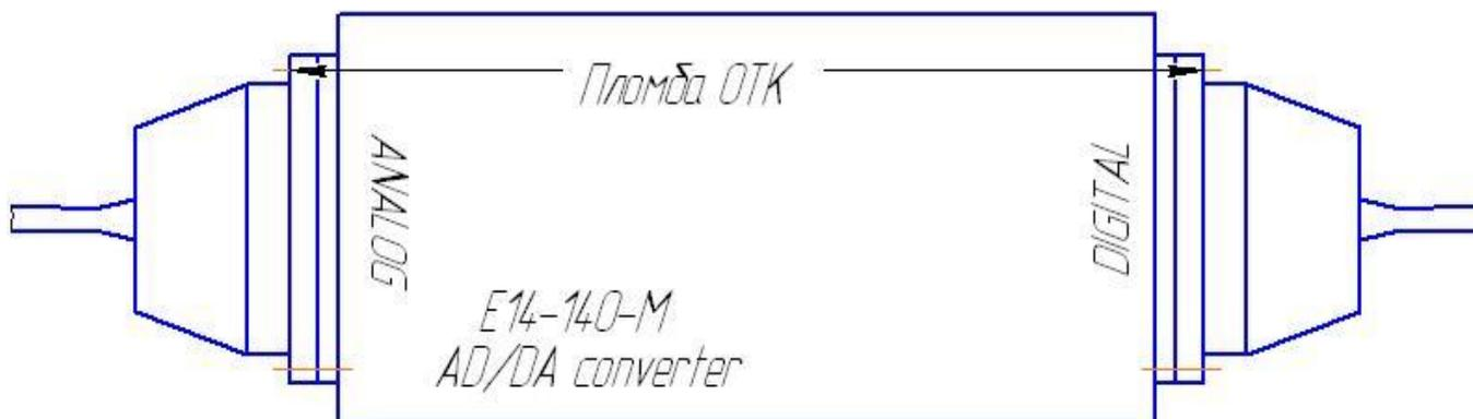
Рисунок 2 Схема пломбировки от несанкционированного доступа, обозначения мест для нанесения оттисков клейм и нанесения наклеек
