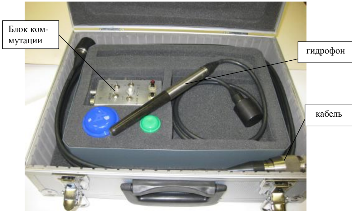
Рисунок 1 - Фотография общего вида гидрофона ГИ55
