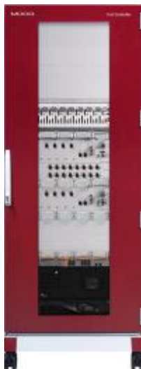
Рисунок 2 – Внешний вид аппаратуры для измерений механических воздействий и управления процессом проведения испытаний изделий машиностроения модели Aerospace Test Controller
