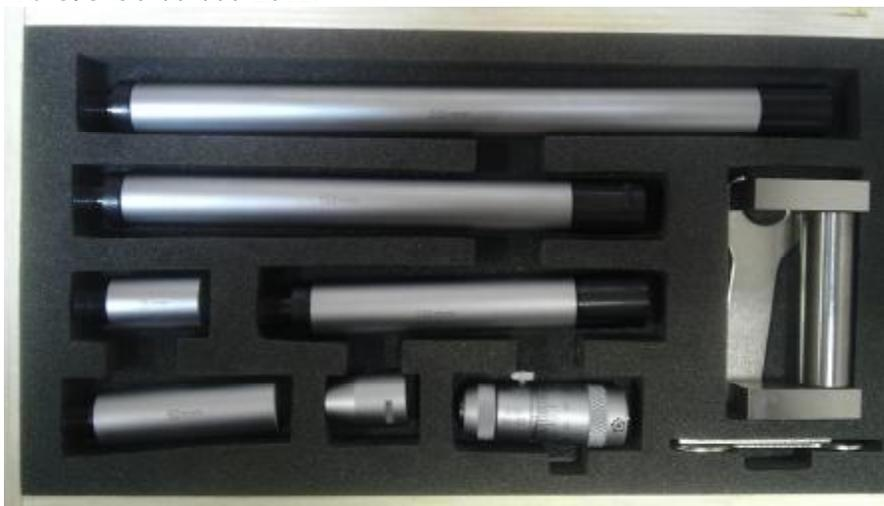
Рисунок 1 - Общий вид нутромеров микрометрических типа НМ
