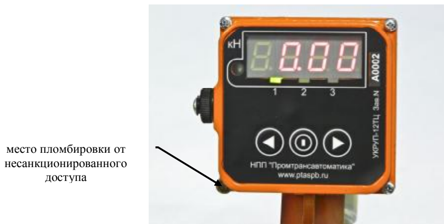
Рисунок 2 – Схема пломбировки от несанкционированного доступа
