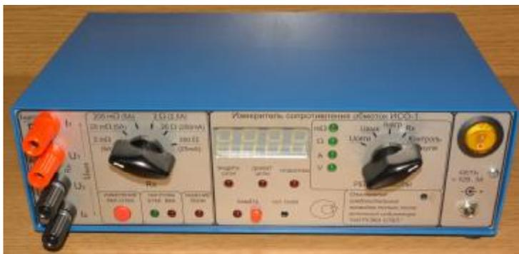
Основные узлы измерителей: стабилизированный источник постоянного тока на несколько фиксированных значений, блок измерения отношений напряжения, масштабные усилители, ограничитель индуктивного выброса, цифровой дисплей с подсветкой и подогревом.
