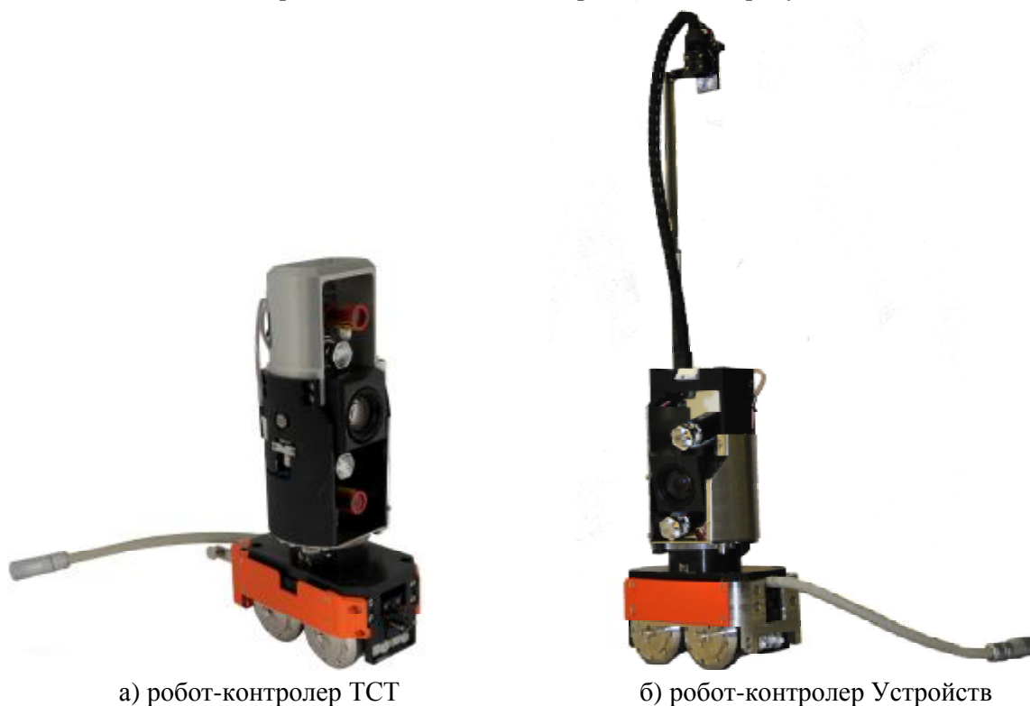
Рисунок 1 - Внешний вид передающей части систем диагностических модернизированных СК-Э-М
