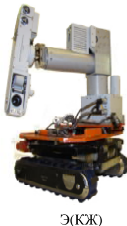
Рисунок 1 – Внешний вид загрузочного устройства а) платформа загрузочная; б) устройство загрузки
