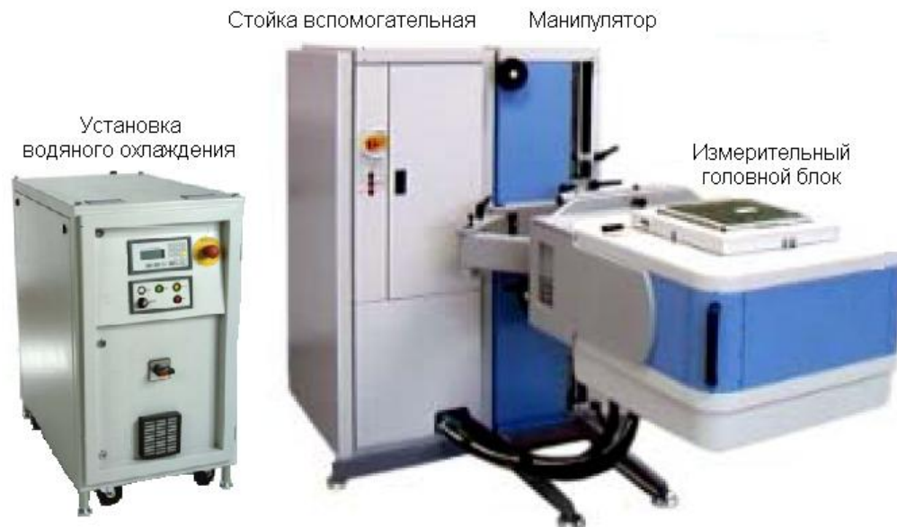
Внешний вид стенда измерительного для СБИС Agilent 93000 С200е
