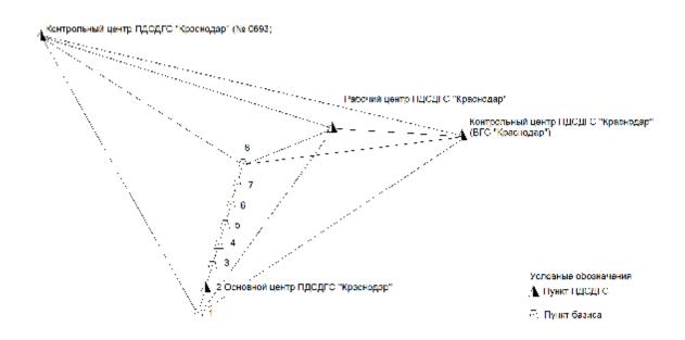
Рисунок 2 - Схема расположения пунктов Полигона (Набор эталонных линий)
