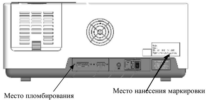
Рисунок 3 - Место нанесения маркировки и место пломбирования спектрофотометров
