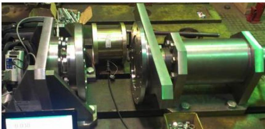
Рисунок 1. Общий вид стенда для измерений крутящего момента силы ММ-140Б
