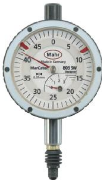
Рисунок 4 – Головка измерительная с отсчетом по круговой шкале MarCator 803 SW
