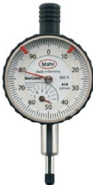
Рисунок 2 – Головка измерительная с отсчетом по круговой шкале MarCator 805 A
