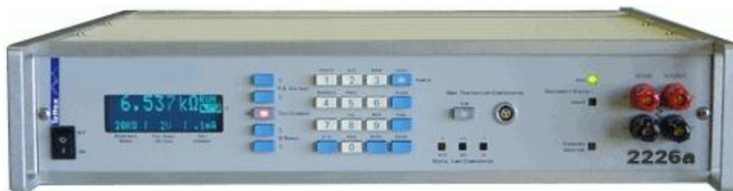
Рисунок 1 – Фотография общего вида микроомметров 2226а
