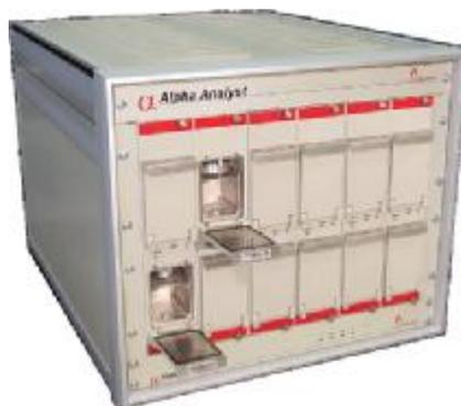
Рис. 1. Фотография общего вида спектрометра Alpha Analyst с установленными измерительными модулями 7200
