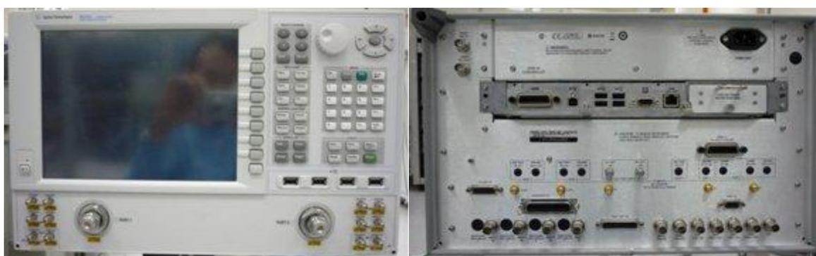
Рисунок 10 Внешний вид анализаторов N5244A, N5245A
