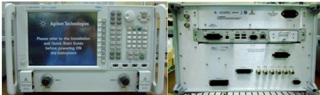
Рисунок 6 Внешний вид анализаторов N5239A
