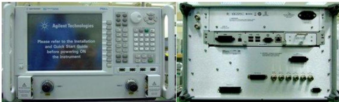
Рисунок 8 Внешний вид анализаторов N5235A
