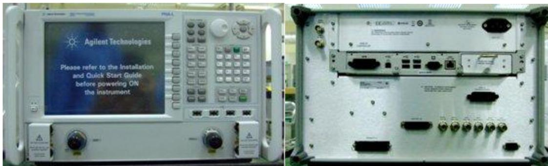
Рисунок 7 Внешний вид анализаторов N5234A,
