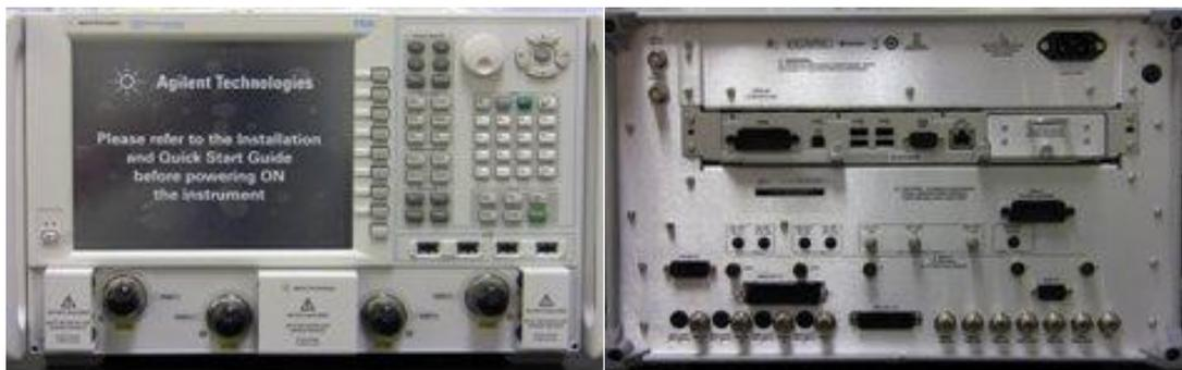
Рисунок 3 Внешний вид анализаторов N5227A
