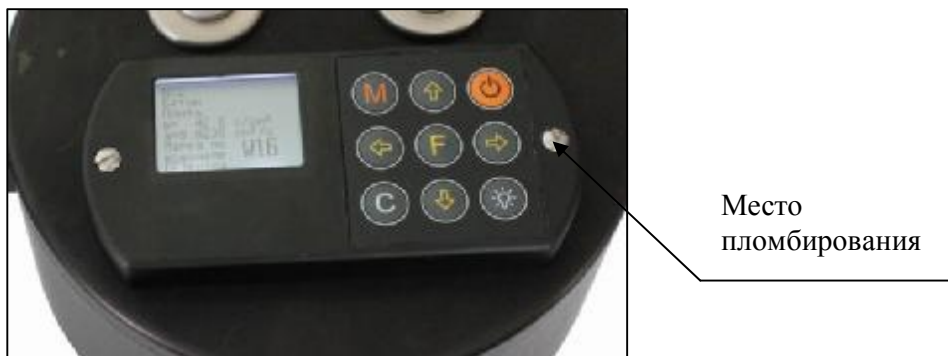
Рисунок 1 - Место пломбирования и клеймения на приборах модификации ВИП-1.1, ВИП-1.2, ВИП-1.3
