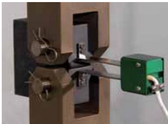
Рис. 2. Внешний вид датчиков перемещений (деформаций) 3541.
