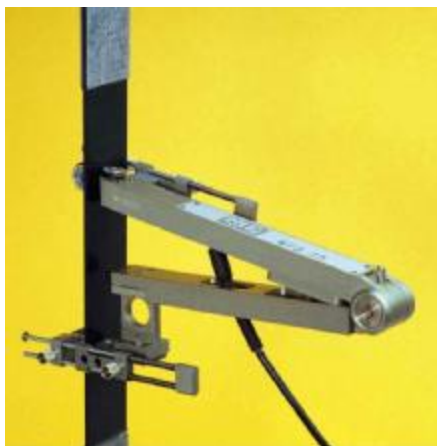
Рис. 1. Внешний вид датчиков перемещений (деформаций) MFA 12, MFA 25.
