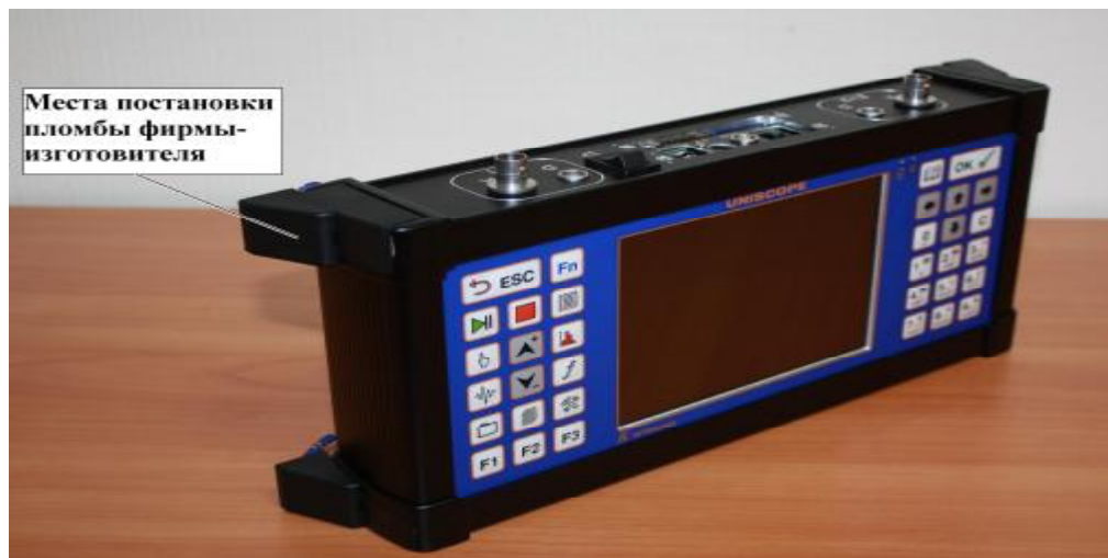
Рисунок 4 – Место пломбировки от несанкционированного доступа
