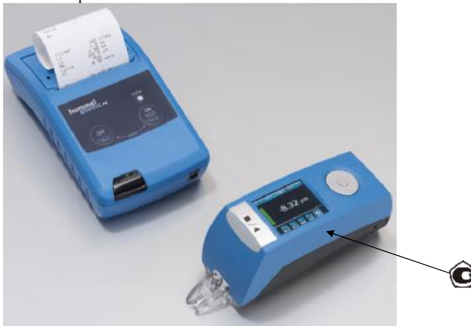
Рисунок 1 Общий вид прибора для измерений параметров шероховатости поверхности HOMMEL-ETAMIC W5
