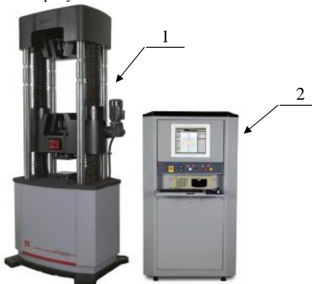
Рис.1 Общий вид машин универсальных испытательных MTS Criterion 60 (1- силовая рама, 2 - интегрированная операционная платформа)
