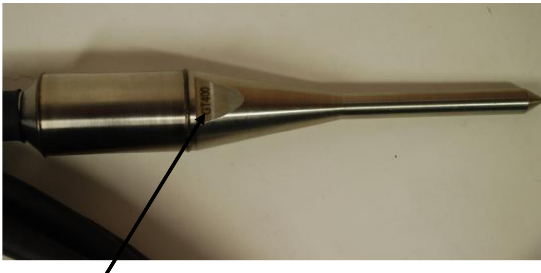
Рисунок 2 - Место для нанесения обозначения типа датчика или размещения наклеек (заводской номер наносится с обратной стороны)
