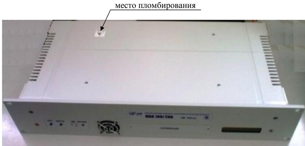
Рисунок 2- Модуль автоматического контроля оптических волокон МАК 100- место пломбирования
