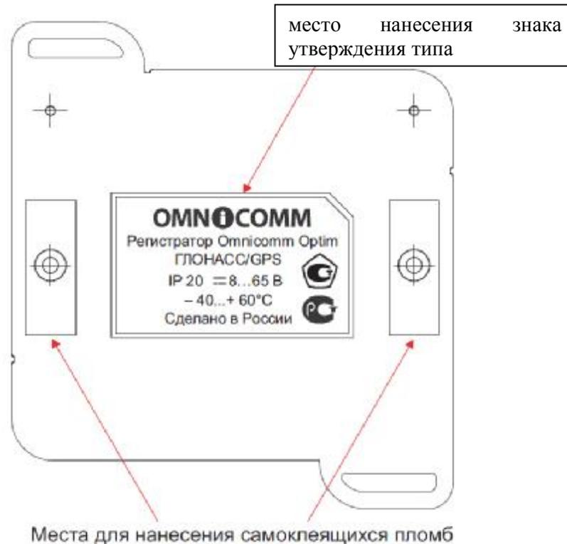
Рисунок 2 – Внешний вид аппаратуры Omnicomm Optim
