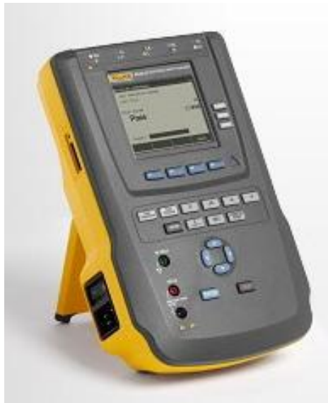
Рисунок 1 – Фотография общего вида анализаторов электробезопасности ESA 615
