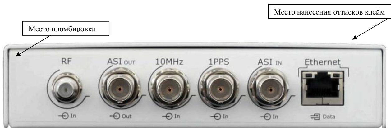
Рисунок 2 Схема пломбировки от несанкционированного доступа и нанесения отпечатков клея
