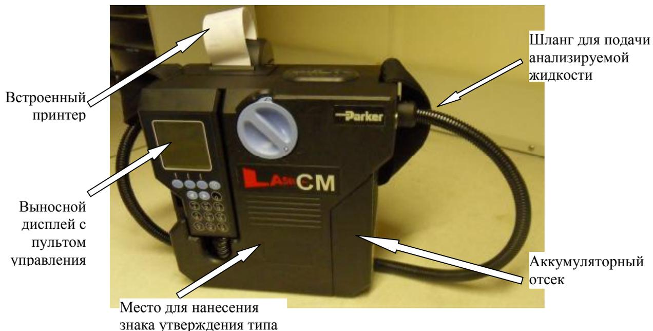
Рисунок 1 - Внешний вид счетчика частиц Parker LaserCM20 и обозначение места для размещения знака утверждения типа
