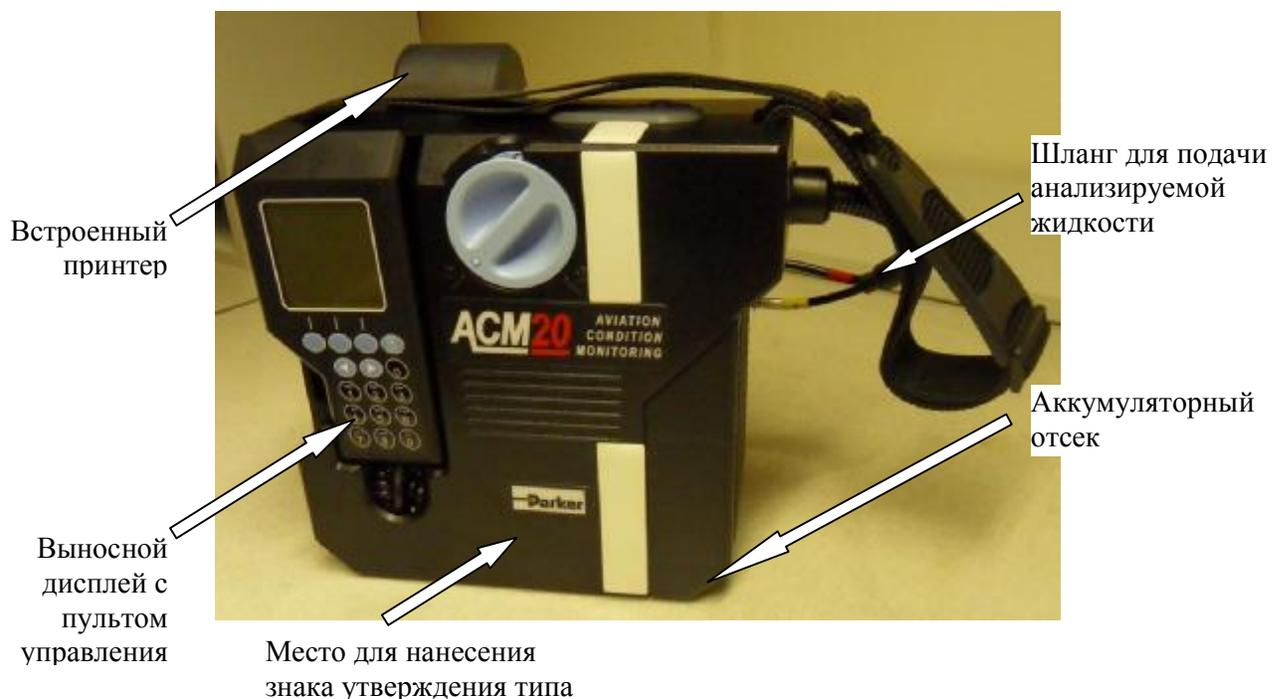
Рисунок 2- Внешний вид счетчика частиц Parker ACM20 и обозначение места для размещения знака утверждения типа
