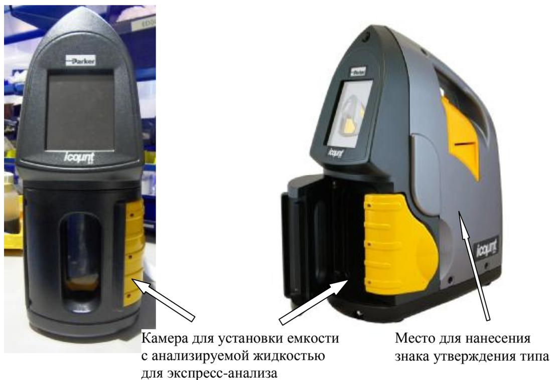
Рисунок 4- Внешний вид счетчиков частиц Parker icount BS, Parker icount BS2 и обозначение места для размещения знака утверждения типа
