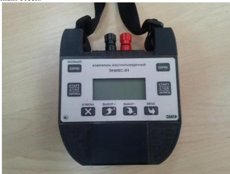
Конструктивно измерители выполнены в виде моноблока в брызгозащищенном корпусе из ударопрочного пластика с ремнем для переноски. На лицевой панели размещены дисплей и кнопки управления. На тыльной стороне корпуса расположен батарейный отсек, закрываемый крышкой с герметизирующей эластичной прокладкой. На верхней панели размещены измерительные клеммы. В нише на нижней стороне корпуса расположен разъем RS-232.
